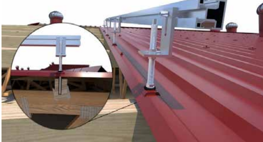
Obr. 7 Kotvenie fotovoltických panelov cez trapézový plech až do nosnej drevenej konštrukcie.
